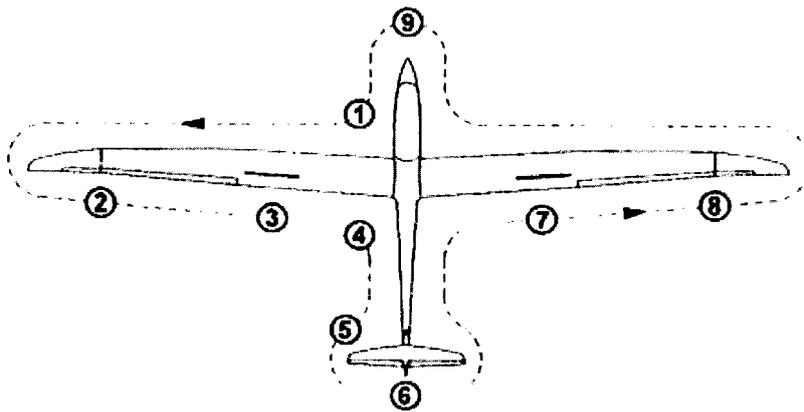
Beim Rundgang um das Flugzeug auf Lackrisse, Beulen und Unebenheiten in der Oberfläche achten; im Zweifelsfalle einen Fachmann zu Rate ziehen.
