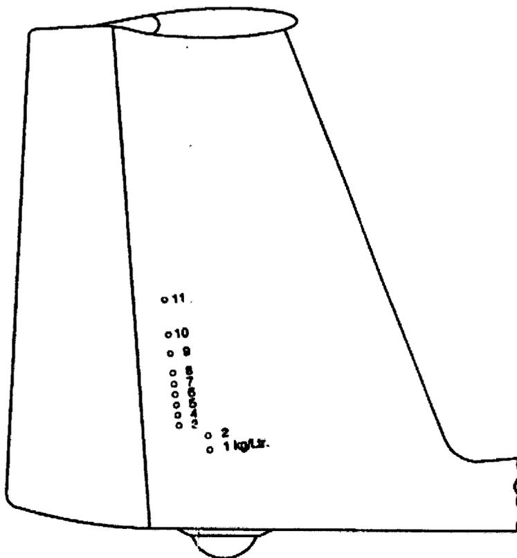
Das Ablassen des Wassers in der Seitenflosse erfolgt durch eine Bohrung im Rumpf vor dem Seitenruder. Der Ablassmechanismus ist mechanisch mit der Betätigung für den Flügelwasserballast gekoppelt, so dass die Wassertanks in den Flügeln und in der Seitenflosse immer gleichzeitig geöffnet werden. Die Auslaufzeit bei vollem Seitenflossentank beträgt etwa 2 Minuten, d. h. er entleert sich immer schneller als die vollen Flügeltanks.
